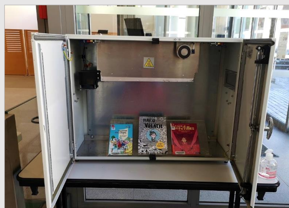
Un présentoir a été confectionné sur mesure pour maximiser les effets de la lumière pulsée sur la surface des documents
